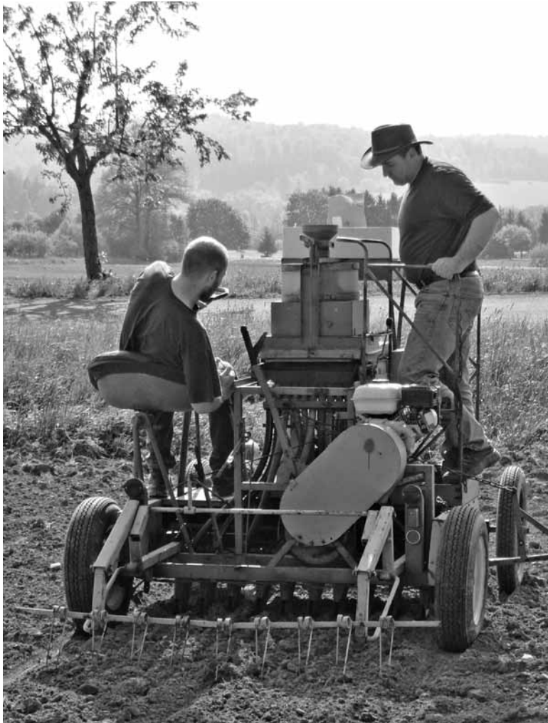
Besonderes Saatgut bedarf auch besonderer Landtechnik: Einer Parzellenbohnenndrille.
